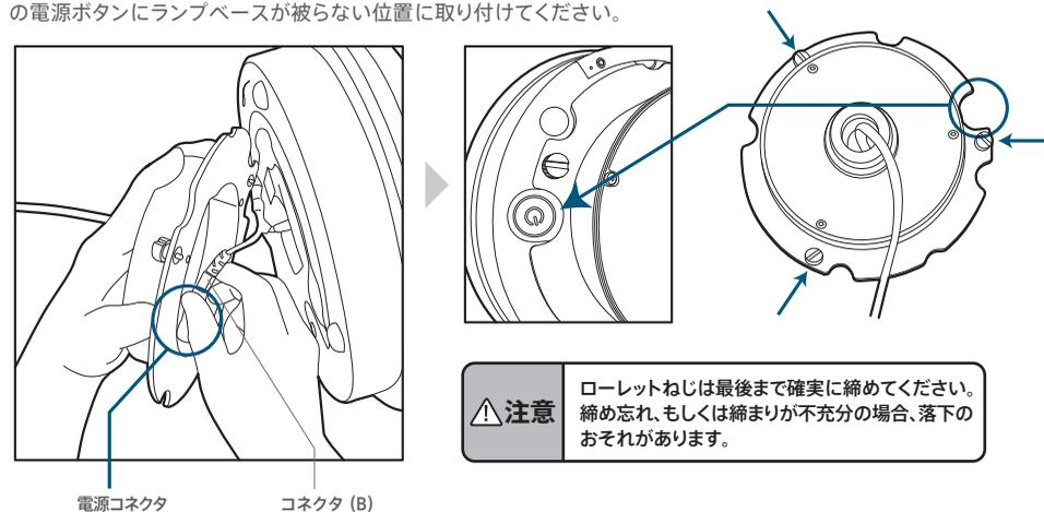
**⚠ 注意** ローレットねじは最後まで確実に締めてください。締め忘れ、もしくは締め込みが不充分の場合、落下のおそれがあります。
