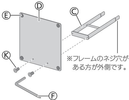
**2** 中央フレームと上フレームをスタンド用ボルトでしっかりと固定します。
